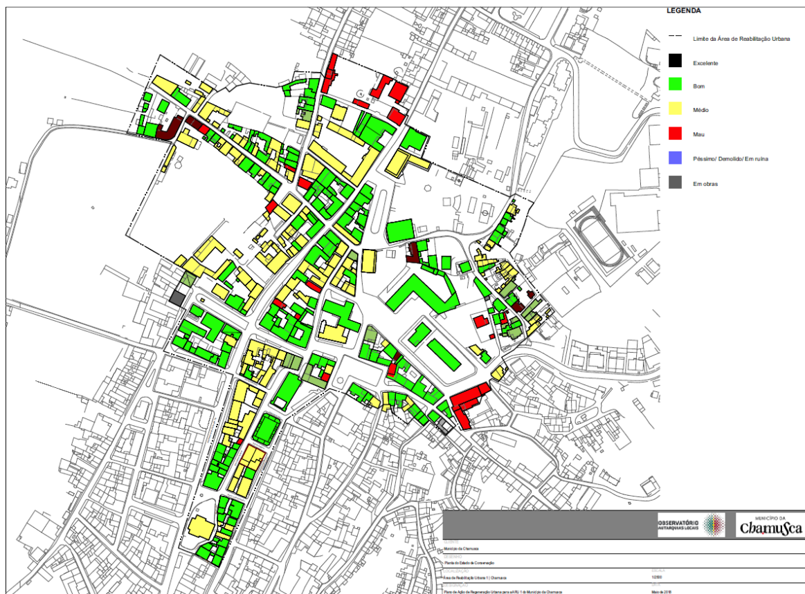
Figura 7 - Estado de Conservação do Edificado da ARU1 do Município da Chamusca
